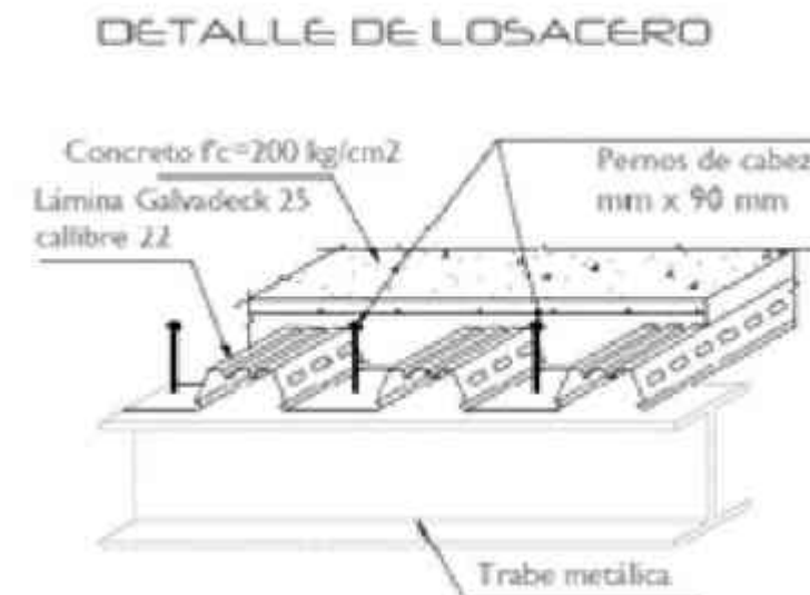
Detalle de Losacero
