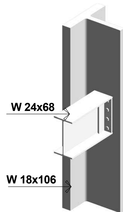
RENDER 3D ESTRUCTURAL UNION DE VIGAS Y COLUMNAS CON TORNILLOS
