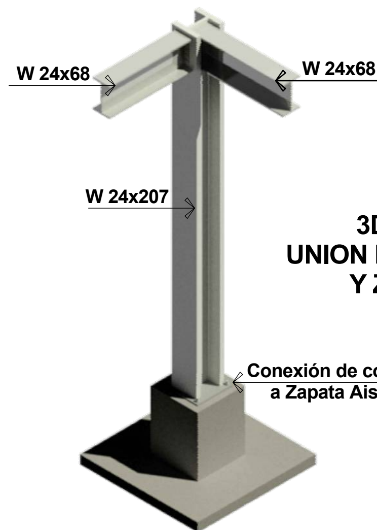
RENDER 3D ESTRUCTURAL UNION DE VIGAS Y COLUMNAS CON TORNILLOS
