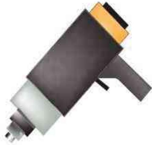
Imagen 64. *Pistola de insensibilización mecánica* Guías de buenas prácticas para diseño establecimiento sacrificio TIF /16-06-2014.
