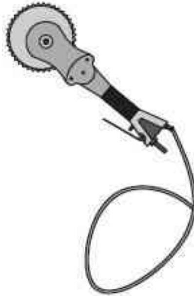
Imagen 52. Desolladora manual neumática, guías de buenas prácticas para diseño establecimiento sacrificio TIF /16-06-2014.
