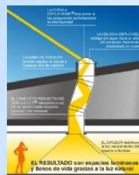
Captación por medio de Tubo de luz
