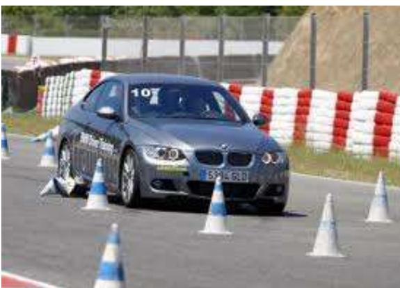
**Slalom:** esta prueba consiste esquivar una serie de obstáculos (conos) a lo largo de una recta con el fin de probar la estabilidad del vehículo y el comportamiento de la dirección del mismo, el piloto prueba su capacidad de reacción para esquivar los obstáculos y cambiar de dirección rápidamente.
