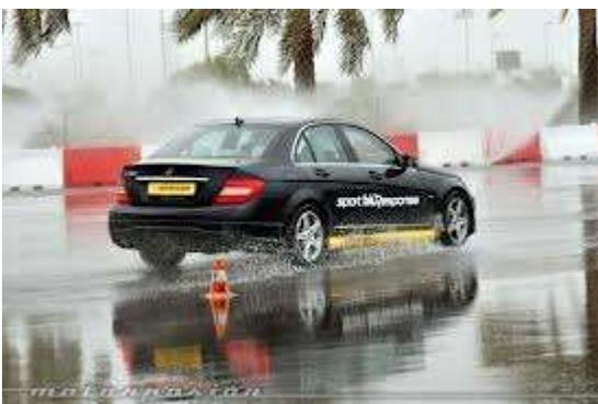
**Prueba de derrape:** consiste tener una parte de la pista mojada y pasar sobre ella con el vehículo y ver que tanto derrape tiene y control de tracción para evitar derrapar demasiado, el piloto debe ser hábil al controlar el vehículo en el menor tiempo posible.
