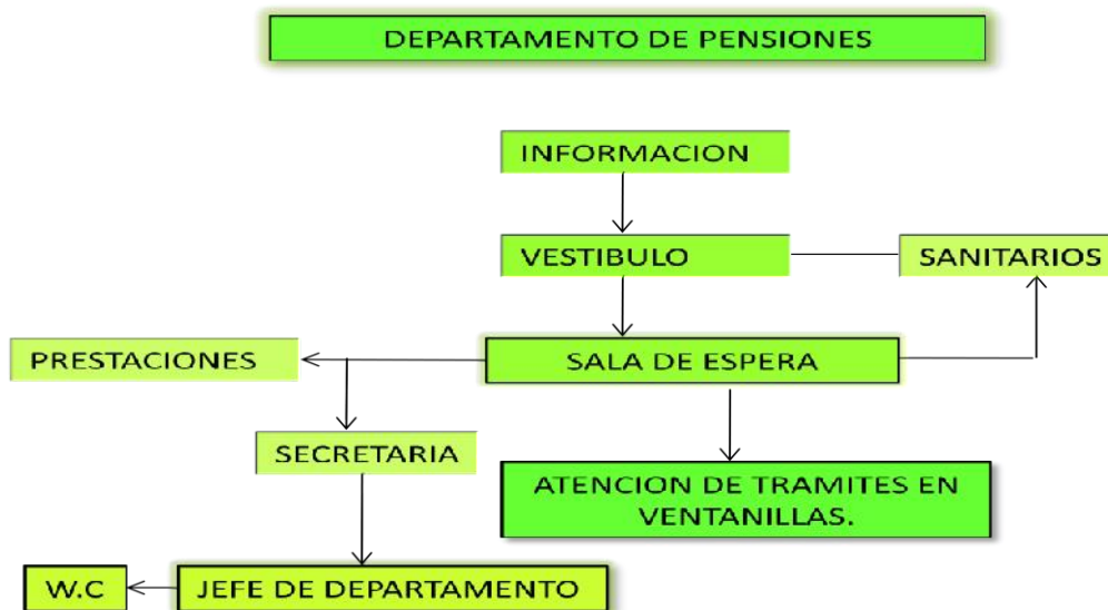
Esquema 6. Diagrama de funcionamiento por departamento de la subdelegación metropolitana del IMSS, realizado por la autora.
