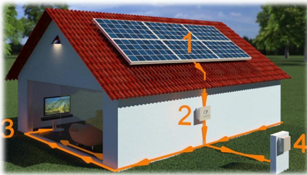
Imagen 37. Función de un panel solar. Fuente: http://www.altenergy.mx/
