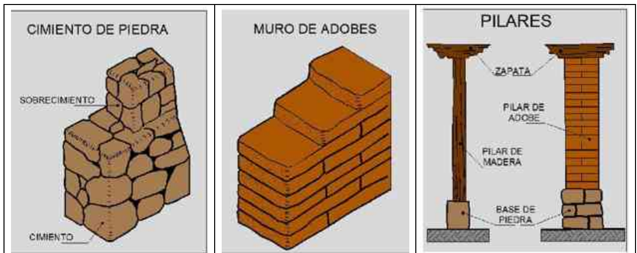
Fig. 44. Materiales de los elementos estructurales
