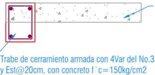
losa de 12cm de espesor armada Var del No.3 en ambos sentidos y con concreto f'c=250kg/cm2
