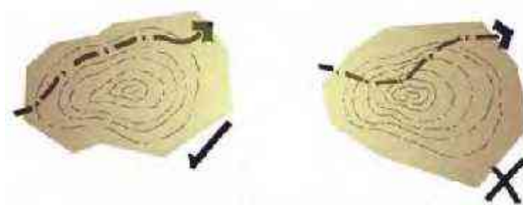
Fig.039 trazo de las vialidades siguiendo las curvas de nivel, para adecuarse al paisaje y evitar cortes y rellenos. Fuente: Fascículo 9 servicios básicos en áreas naturales guía para el diseño de servicios turísticos básicos en sitios naturales. Secretaría de turismo.
