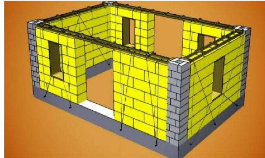
Ilustración 65 Amarre de pacas. En captura de video. SEMARNAT, CONAFOR. Tecnologías alternativas para el uso eficiente de recursos. México, 2008.
