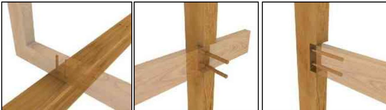
Imagen 69. Uniones de vigas. Fuente: [http://es.slideshare.net/catedradiez/unidad-11-estructura-de-techumbre1?next\\_slideshow=1](http://es.slideshare.net/catedradiez/unidad-11-estructura-de-techumbre1?next_slideshow=1)
