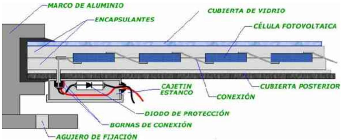
Imagen 79. Partes que componen un panel solar. Fuente: panel fotovoltaico, [http://www.ujaen.es/investiga/solar/07cursosolar/home\\_main\\_frame/04\\_componen/01\\_generador/01\\_basico/4\\_gene\\_01.htm](http://www.ujaen.es/investiga/solar/07cursosolar/home_main_frame/04_componen/01_generador/01_basico/4_gene_01.htm). 20/02/2014.
