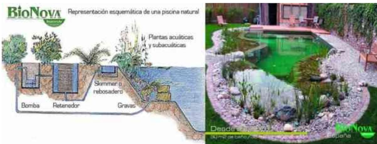
Imagen 83. Sistema de funcionamiento de una piscina natural. Fuente: BioNova natural pool, Precios de piscinas naturales, <http://www.bionovapiscinasnaturales.com/gama-de-piscinas/precios/>, 05/04/2014.
