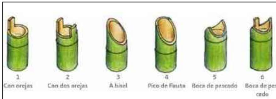
Imagen 66. Tipos de corte de bambú. Fuente: [http://www.cauem.org.mx/documentiManual\\_para\\_la\\_Construccion\\_Sustentable\\_con\\_Bambu.PDF](http://www.cauem.org.mx/documentiManual_para_la_Construccion_Sustentable_con_Bambu.PDF), 28/03/2014
