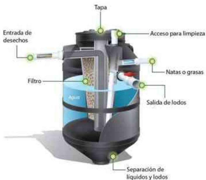
Imagen 73. Funcionamiento del biodigestor. Fuente: <http://proconsrl.com/biodigestores-rotoplas.php>
