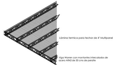
**DETALLE CUBIERTA DE LAMINA**
