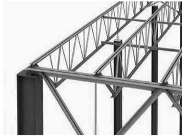
Imagen 87 Cubierta Tipo Joist https://toldosyestructuras.wordpress.com/quienes-somos/
