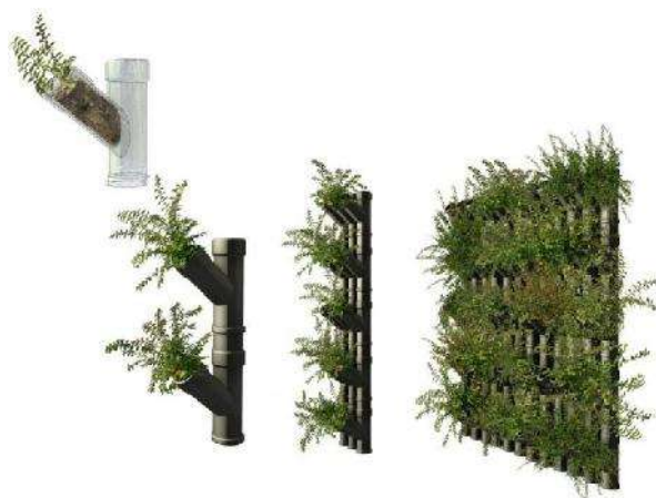
Imagen 117.- Caso 1, sistema de tuberías de riego a base de PVC
