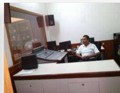
Imagen 72.- Fotografía de cabina de producción y edición, cuenta con el espacio para albergar al equipo necesario e instalaciones ocultas en dobles revestimientos de muro, acústicamente hermética. Por Juan A. Camarillo León.
