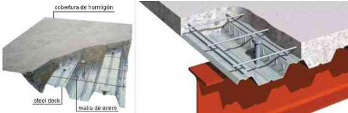
Ilustración 4 Detalle de Losacero, con pernos soldados a la trabe, para evitar el desplazamiento de la misma, una malla electro-soldada para evitar fractura del hormigón con espesor mínimo de 12 centímetros. (Google, 2015)
