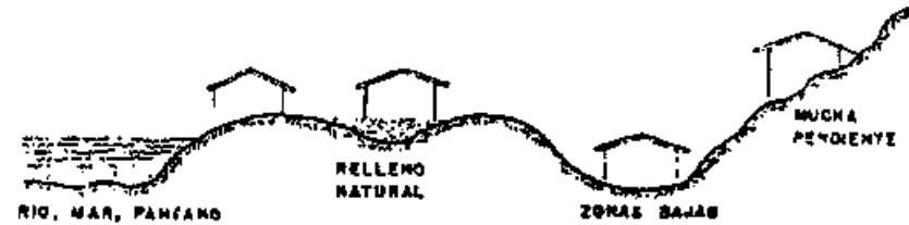
Figura 1 Ejemplo de donde diferentes localizaciones de construcciones en adobe.
