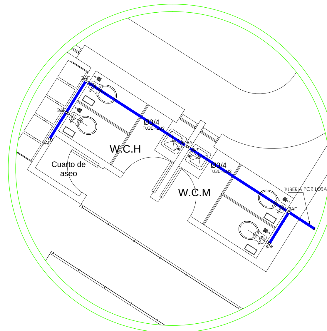
DETALLE HIDRAULICO 2 (D-2)
