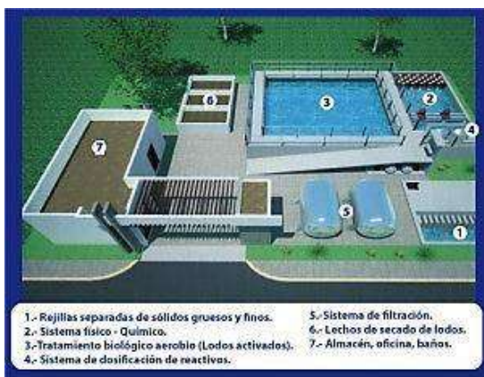
Imagen 76.- Planta tratadora de agua. Fuente: http://www.adcsapem.com.ar/?page_id=334
