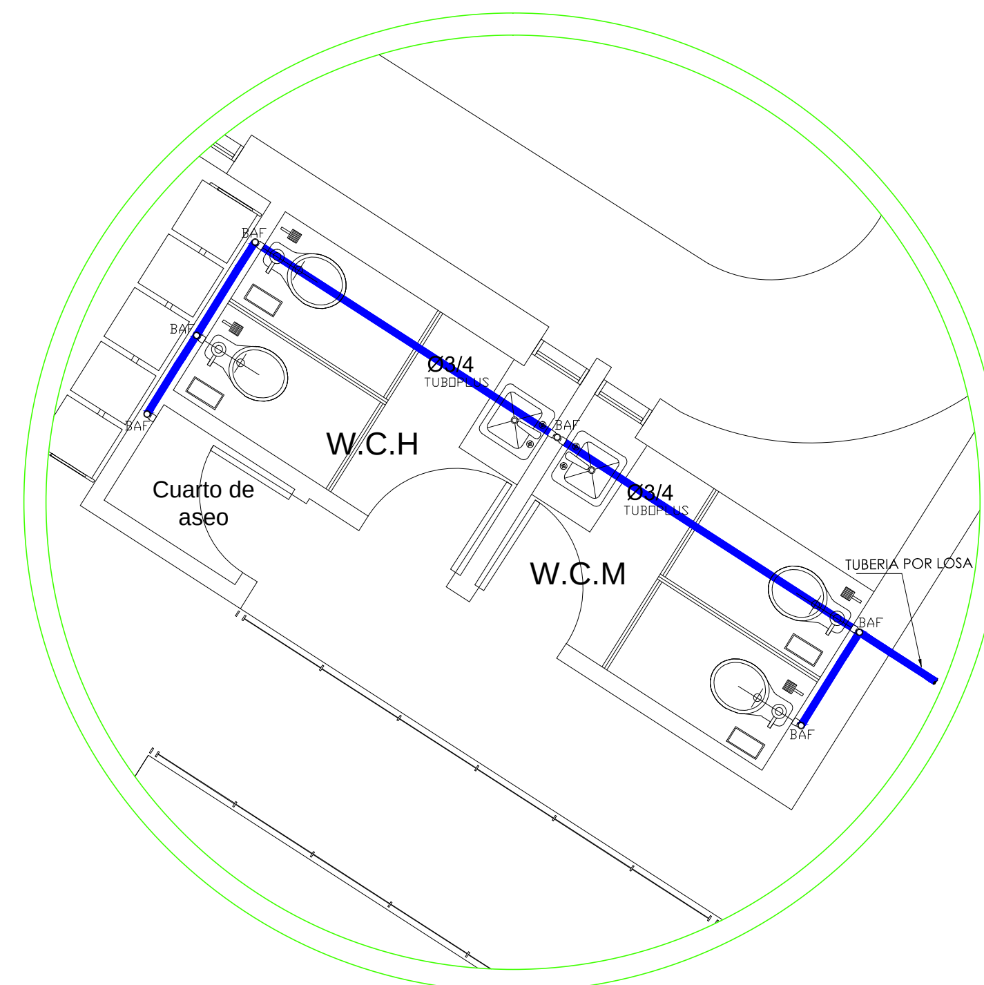
DETALLE HIDRAULICO 2 (D-2)
