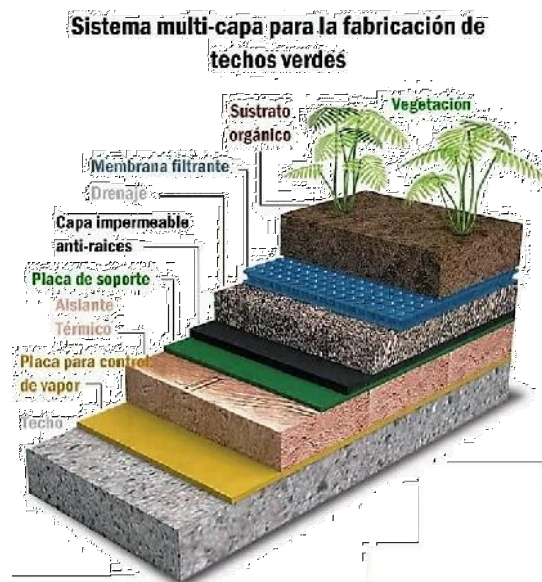
Imagen 74.- Sistema multicapa techos verdes. Fuente: http://es.slideshare.net/lapriel/techos-verdes
