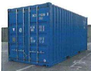
Imagen No. 13.- Contenedor Dry Van de 20 ft. (6.10 mts. de largo)
