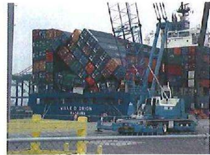
Imagen No. 15.- Accidente de un derrumbe de contenedores.
