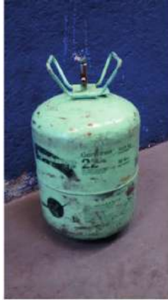
Figura 71. Boya de Gas Refrigerante R-22 de 13.60kg. El color verde pistache del tanque es el que identifica el tipo de Refrigerante
