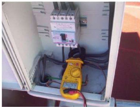
Figura 53 Toma de lecturas con el amperímetro. Tomada en Plaza Las Américas. 18/Feb/2010 (AEAF)
