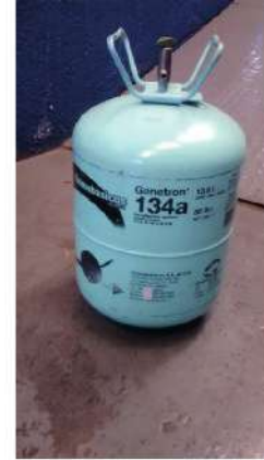
Figura 74 Boya de gas refrigerante R-134 a , en presentación de 13.60 kg. El color azul agua del tanque indica el tipo de refrigerante
