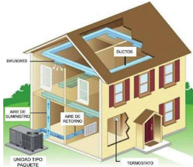
Figura 41 Ubicación de equipos y distribución de ductos del sistema de aire acondicionado tipo paquete. <aireacondicionado.com> consultada el 20/Ene/2016
