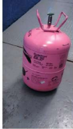
Figura 72 Boya de gas refrigerante R-410. Boya de 13.60 kg. El color salmón del tanque es el que identifica el tipo de refrigerante
