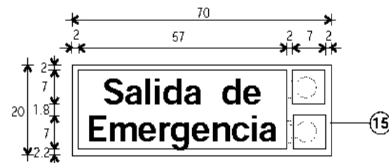
LÁMPARA DE SALIDA DE EMERGENCIA UNA Y DOS CARAS. VISTA FRONTAL
