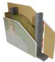
Ilustración 94. Muros divisorios con tablero de yeso
