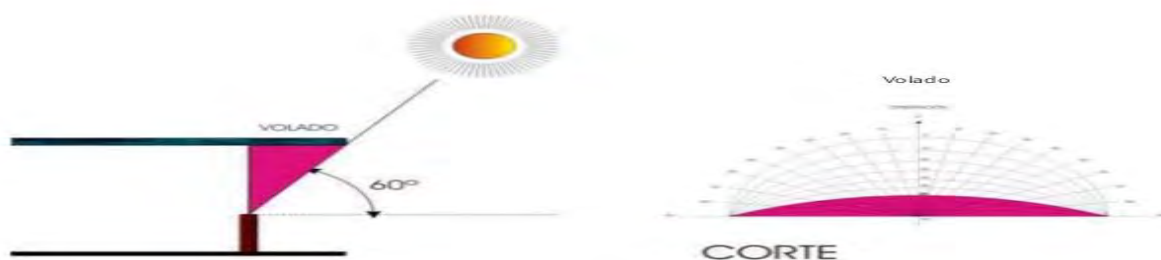
IMAGEN 056: ANALISIS DE PARTESOL ELEMENTO CONSTRUCTIVO CON DETERMINADA FORMA: VERTICAL, HORIZONTAL Y DIAGONAL. EL CUAL NOS AYUDA HACER UN CORTE EN LA LUZ DEL SOL PROYECTANDO UNA SOMBRA AL INTERIOR, MEJORANDO LA TEMPERATURA TANTO EN VERANO Y EN EL INVIERNO DEJANDO PASAR AL SOL. (2005) ARCHIVO PERSONAL
