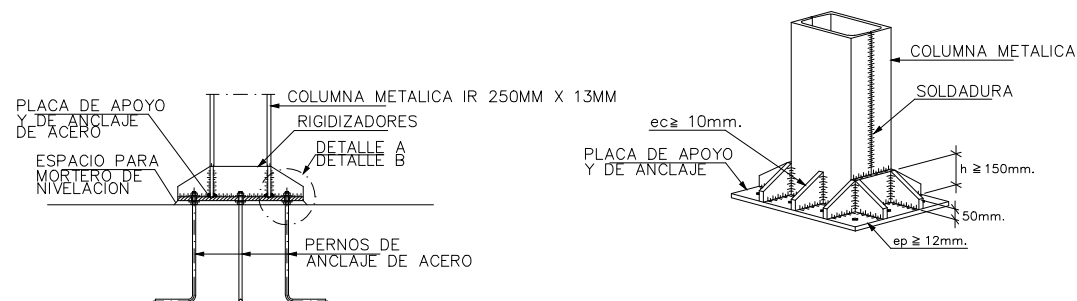
DETALLE DE ANCLAJE DE COLUMNA (C1)
