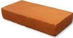
**Tabique rojo recocido:** El tabique rojo, es una pieza de cerámica, generalmente en forma rectangular, obtenida por moldeo, secado y cocción a altas temperaturas, a partir de una pasta arcillosa.
