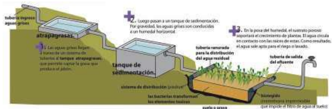
Imagen 35: Pilas de rehabilitación de agua
