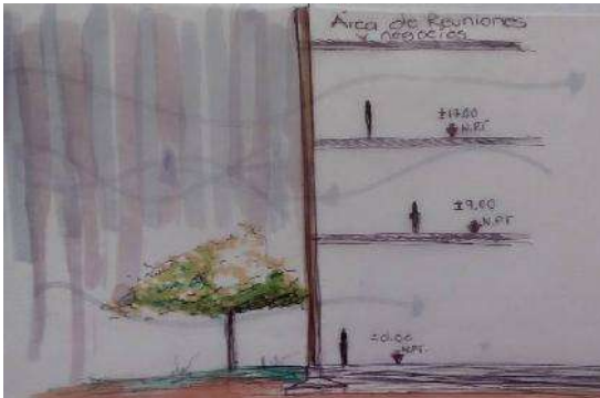
Ilustración 90. Croquis de escala de los tres niveles del área de convenciones y el flujo de viento del exterior al interior del edificio. Elaboración Propia.
