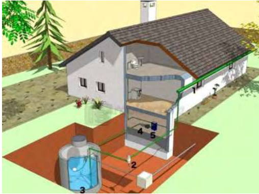
Imagen 62.- Diagrama de captación pluvial.
