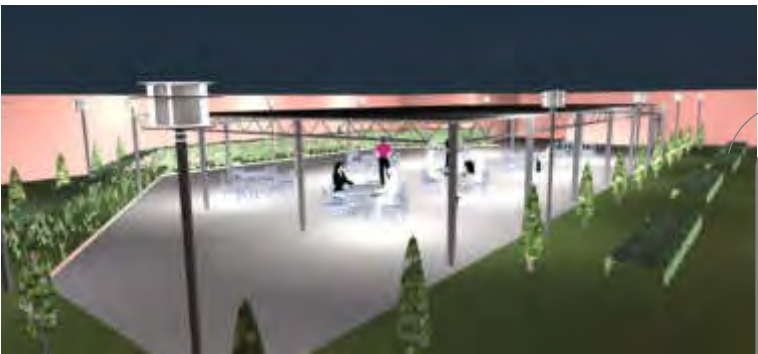
ILUMINACION DE JARDIN EN AZOTEA CON lampara fluorecente de arranque rapidos de luz blanca sin transmision de calor y Luminario punta de poste para lámpara A.M. 175W
