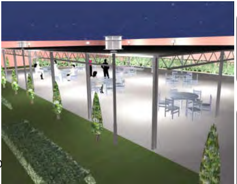
ILUMINACION DE JARDIN EN AZOTEA CON lampara fluorecente de arranque rapidos de luz blanca sin transmision de calor y Luminario punta de poste para lámpara A.M. 175W
