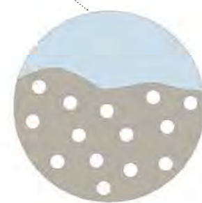
LODO microorganismos disuelven y degradan los sólidos orgánicos.
