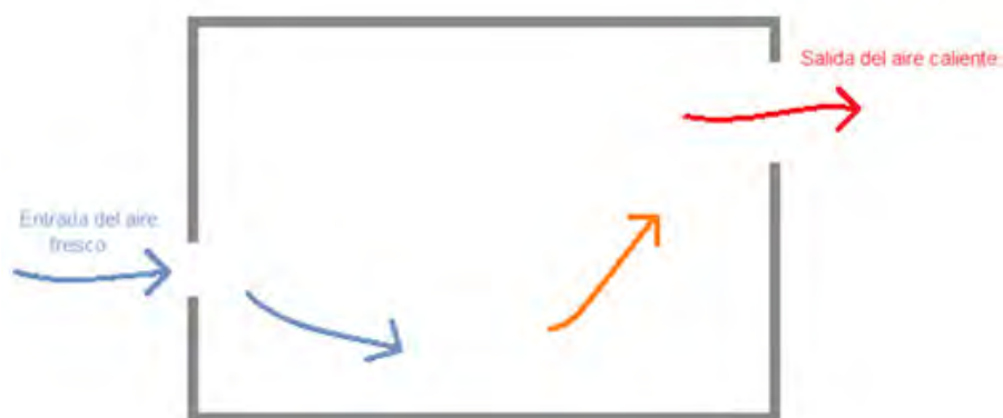
Gráfica 3. Vista en corte de un espacio que ejemplifica la colocación de las ventanas para lograr inducir el aire fresco al interior y extraer el aire caliente de él.
