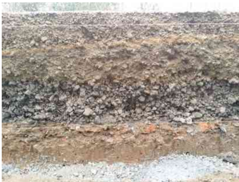
Imagen 5. Fotografía de las capas de mejoramiento y estratigrafía del terreno natural. (Tomada por Karim Alan Corona Hernández)
