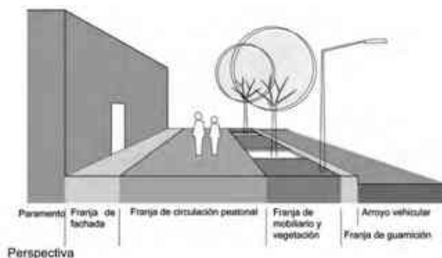
Img. 151 especificaciones para banquetas, fuente: http://www.seg.guanajuato.gob.mx/prepaabierta/docs/4.pdf , consulta: mayo 2017.
