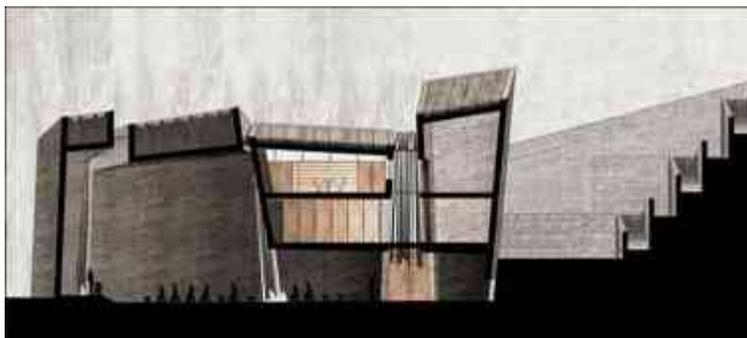
IMG 4. Corte transversal. Podemos observar las diferentes alturas de los volúmenes así como las plataformas del terreno y la ubicación de los diferentes espacios.
