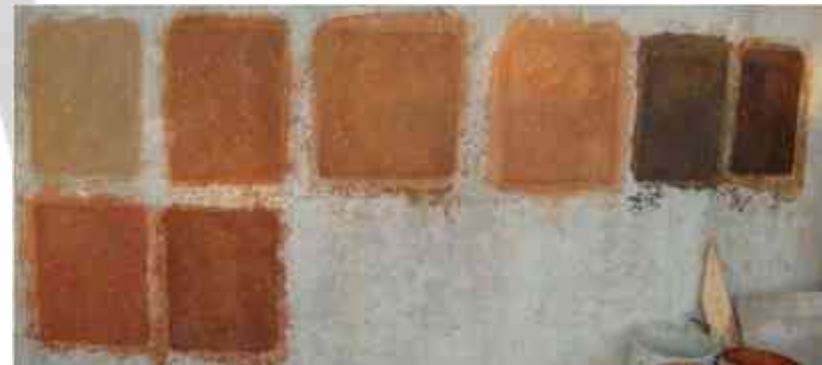
IMAGEN 42. PRUEBAS DE MEZCLA DE TIERRA CON DIFERENTES CLASES DE TIERRA. FUENTE: LEWIS, MICHEL. (2011). ARQUITECTURA SUSTENTABLE. RECUPERADA DE: http://arquitecturasustentable.com.mx/aplanados-con-tierra/
