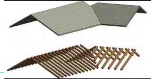
VISTA EN PERSPECTIVA DE LA ESTRUCTURA EN LAS CUBIERTAS INCLINADAS DE AZOTEA
