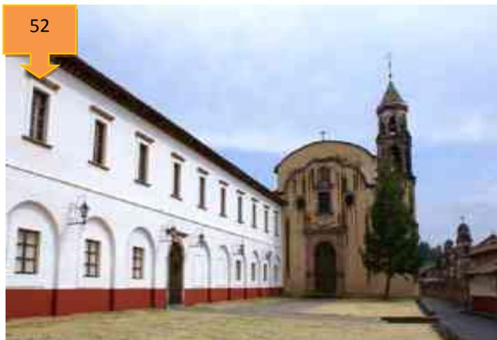
La arquitectura de la ciudad en su mayoría tiene techos inclinados debido a las lluvias que se presentan en el año, la pendiente de estas cubiertas permite que el agua tenga una salida y no se genere humedad en las construcciones, en el proyecto se propone una cubierta inclinada.
