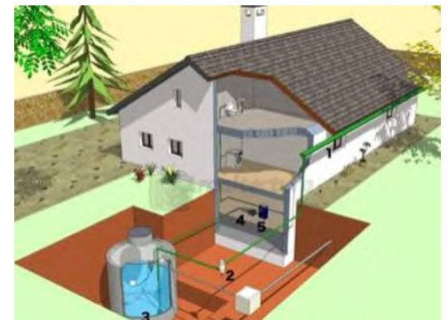
Imagen 112. Sistema de captación pluvial residencial
