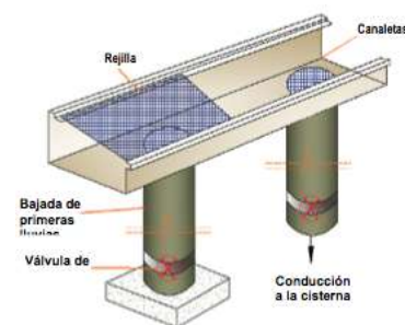
Imagen 114.Canaleta con protección de sólidos
