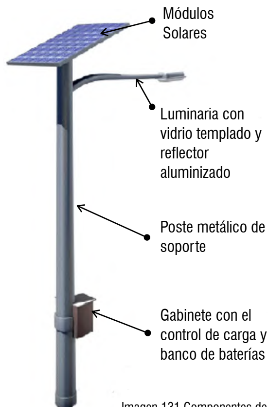
Imagen 131. Componentes de una luminaria con celdas fotovoltaicas
