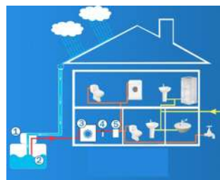
Imagen 95. Captación de Agua Pluvial
