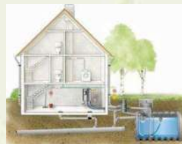
Ilustración 41 instalación de captación y cisternas de captación de agua pluvial
