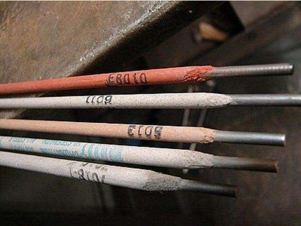
*Fig. 27. Electrodos para soldadura eléctrica.
