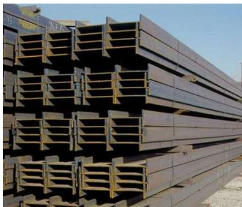
Imagen 33: Perfiles de acero IPR acero A-36
