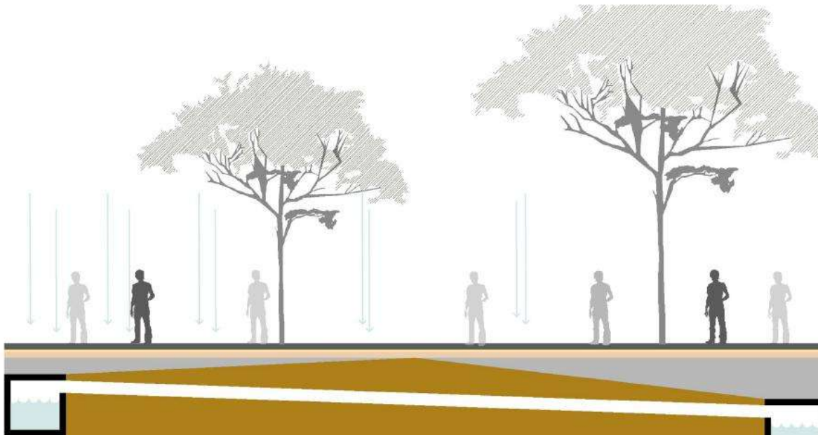
Representación de sistema de captación de agua pluvial a base de pavimento 100% permeable. Elaborada propia
