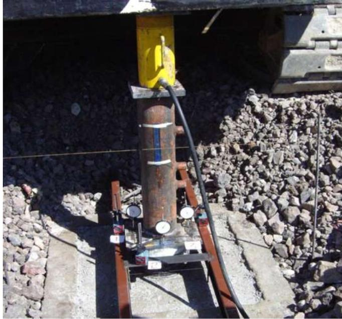
**Figura 53.** Ejecución de prueba de carga para el Conjunto Habitacional Campestre del Vergel, Morelia. **Fuente:** Pilotec (2006).
