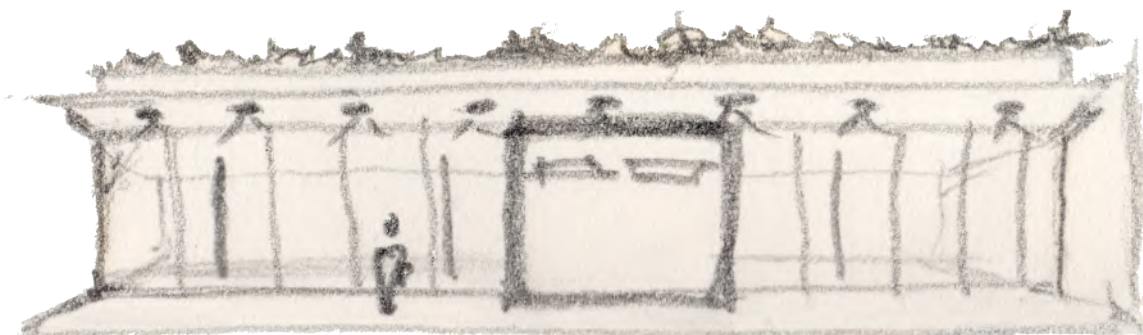
Fig. 7.12 Esquema de la fachada oriente. Por ser la que recibe menor incidencia solar, se emplean grandes acristalamientos. JPGP.
