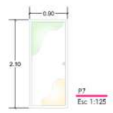
Puerta abatible de vidrio claro templado, una hoja: 10mm de espesor, con antepecho, película de seguridad y película decorativa sobre diseño.
