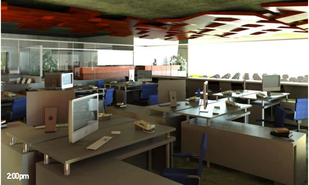
FIGURA 129. Render interior del edificio del pasillo principal en planta baja donde se puede apreciar los dos tipos de plafón anteriormente mencionados; el Panel de Cemento Permapase y el módulo de madera suspendido. Render elaborado por el autor.
