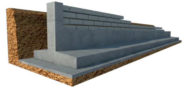
Figura 43: zapata corrida. Elaboración propia: [fecha de elaboracion: octubre 2017].
