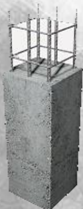
Detalle de columna de concreto.
