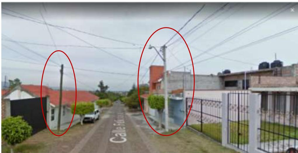
*Ilustración 14 Infraestructura aérea a base se cableado soportado en los tradicionales postes de madera y concreto. Imagen tomada de google edición propia*
