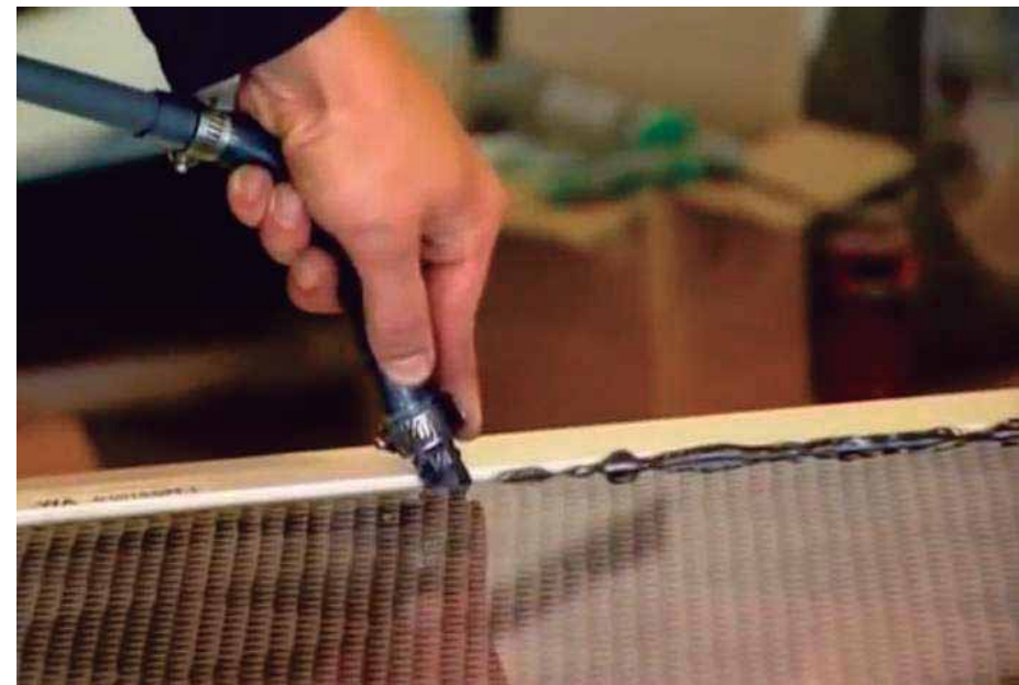
Ilustración 56. Aplicación de silicona en la junta generada al colocar la placa de frito cerámica en el bastidor para su montaje en los perfiles OC DE 6". Obtenida de: https://www.youtube.com/watch?v=UgePsdpKtco . 19/06/18
