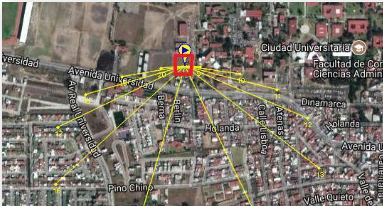
Figura 36: gráfica solar, de los rayos del sol, el terreno propuesto es el de color rojo, en Morelia 2017, imagen obtenida: https://www.sunearthtools.com/dp/tools/pos_sun.php?lang=es
